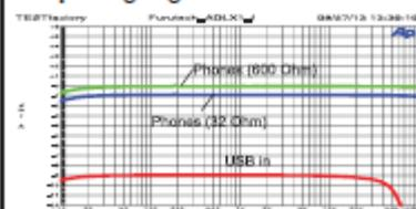
Sehr ausgewogen, recht laststabil, auch via USB mit 63 kHz Bandbreite
